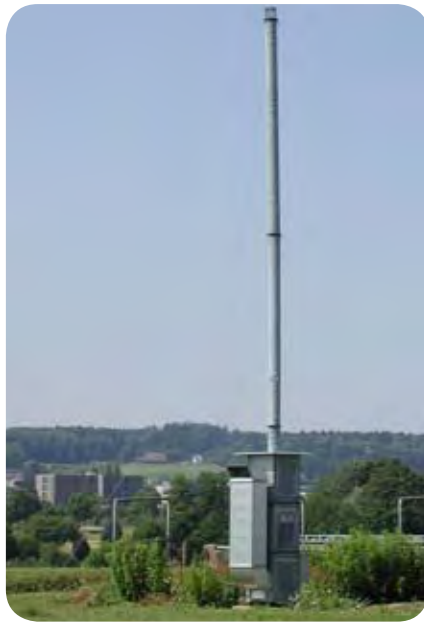
Abbildung 17: Saugfallen in Reckenholz und Changins zur täglichen Ermittlung der Blattlauszahl.
